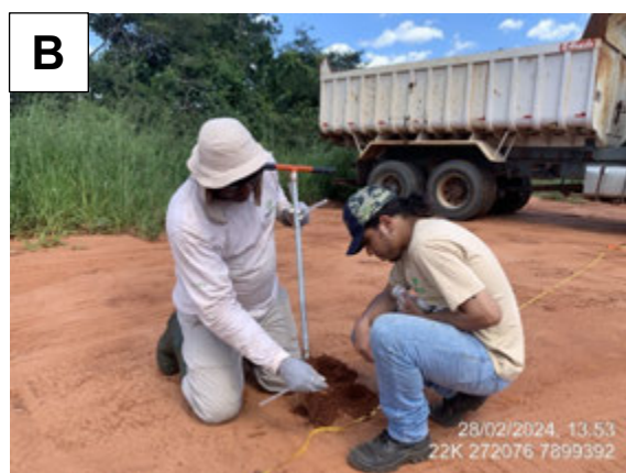
Figura 6-2: (A) Percorrimento de uma distância de 10 metros a favor da curva de nível, tomando como referência a potencial fonte geradora na área CONT-P04-JU-MD; (B) Metodologia de coleta das amostras na área CONT-P03-JU-MD, local onde se encontra o Canteiro Industrial durante a fase de instalação da PCH Fundãozinho, Paraíso das Águas, MS. Novembro de 2023 a fevereiro de 2024.
